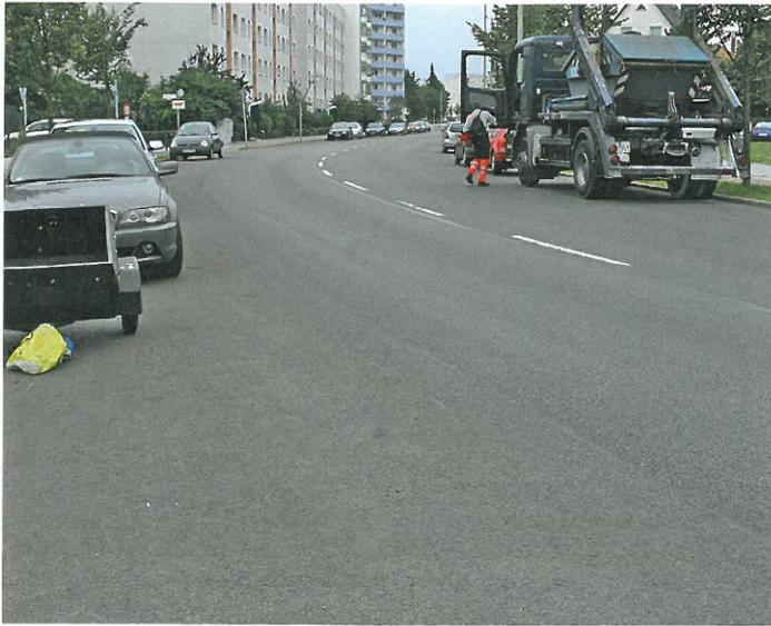
*Bild 1: Beispiel für eine Fahrbahnoberfläche mit einem ebenen, augenscheinlich dichten, bindemittelreichen Oberflächenzustand: StraÙe Segefliegerdamm.*
